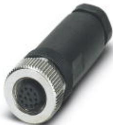
Steckverbinder, Universal, 12-polig, Buchse gerade M12, A-kodiert, Lötanschluss, Rändelmaterial: Zinkdruckguss, vernickelt, Kabelverschraubung Pg9, Kabelaußendurchmesser 6 mm ... 8 mm
