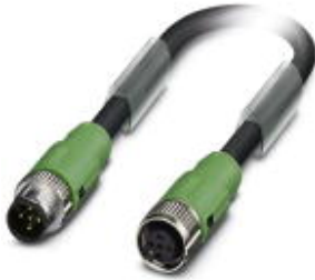
Sensor-/Aktor-Kabel, 5-polig, PUR, schwarzgrau RAL 7021, Stecker gerade M12 SPEEDCON, A-kodiert, auf Buchse gerade M12 SPEEDCON, A-kodiert, Kabellänge: 0,3 m
