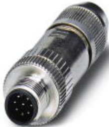
Bussystem-Steckverbinder, Ethernet CAT5, Ethernet CAT5e, 8-polig, geschirmt, Stecker gerade M12, A-kodiert, Schneidklemmanschluss, Rändelmaterial: Zinkdruckguss, vernickelt, Kabelaußendurchmesser 4 mm ... 8 mm
