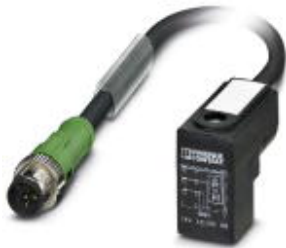
Sensor-/Aktor-Kabel, 3-polig, PUR halogenfrei, schwarzgrau RAL 7021, Stecker gerade M12 SPEEDCON, A-kodiert, auf Ventilstecker C (8 mm), mit 1 LED, beschaltet mit Z-Diode, Kabellänge: 3 m
