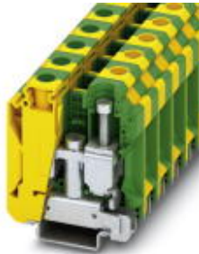
Schutzleiter-Reihenklemme, Anschlussart: Schraubanschluss, Querschnitt: 10 mm 2 - 35 mm 2 , AWG: 8 - 2, Breite: 16 mm, Farbe: grün-gelb, Montageart: NS 35/7,5, NS 35/15, NS 32
