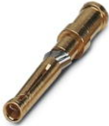
Gedrehter 1,6er Crimpkontakt, Buchsen-Einzelkontakt, Aderquerschnitt 0,14 bis 0,37 mm 2 , vergoldet
