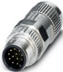
Sensor-/Aktor-Steckverbinder, Stecker, gerade, 12-polig, M12-SPEEDCON, Metallrändel, Piercecon®, Kabeldurchmesser max. 8,2 mm
