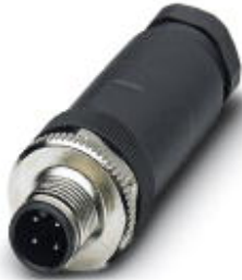
Sensor-/Aktor-Stecker, Stecker, gerade, 4-polig, M12, A-kodiert, Schraubanschluss, Metallrändel, Kabelverschraubung Pg9
