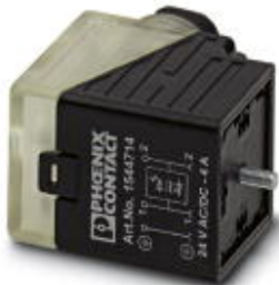
Ventilstecker, 3-polig, Bauform A, 1 LED, mit Schutzbeschaltung, Schraubanschluss, Kabelverschraubung M16
