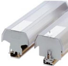
Plombierbarer Abdeckprofilträger, zur Montage auf NS 32-Tragschiene, zur Befestigung des Abdeckprofils AP 3 mit Kunststoff-Rändelmutter M5, Platzbedarf: 13 mm
