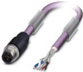
Bussystem-Kabel, CANopen ® , DeviceNet ™ , CANopen ® /DeviceNet ™ , 5-polig, PUR halogenfrei, violett RAL 4001, geschirmt, Stecker gerade M12, A-kodiert, auf freies Leitungsende, Kabellänge: 5 m
