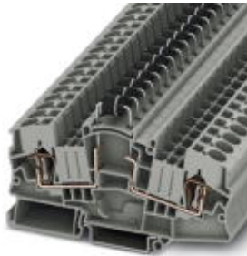
Bauelementreihenklemme, Anschlussart: Zugfederanschluss, Querschnitt: 0,2 mm 2 -10 mm 2 , AWG: 24 - 10, Breite: 8,2 mm, Farbe: grau
