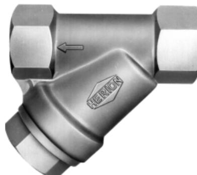
Zum Ausbau des Filtersiebes muß ein Mindestabstand (Rohrmitte bis Störkante 2 x Maß H) vorgesehen werden.
