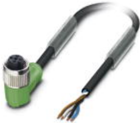
Sensor-/Aktor-Kabel, 4-polig, PVC, schwarz RAL 9005, freies Leitungsende, auf Buchse gewinkelt M12, A-kodiert, Kabellänge: 5 m
