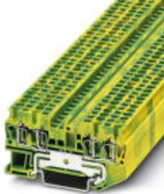
Schutzleiter-Reihenklemme, Anschlussart: Zugfederanschluss, Querschnitt: 0,08 mm 2 - 4 mm 2 , AWG: 28 - 12, Breite: 5,2 mm, Farbe: grün-gelb, Montageart: NS 35/7,5, NS 35/15
