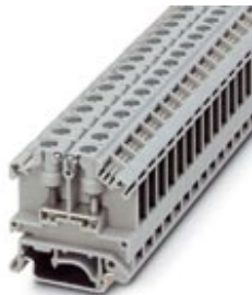
Universalklemme mit Bolzen-Anschluss, mit Prüfbuchsen-schrauben, Querschnitt: 0,1 - 2,5 mm 2 , Breite: 9 mm, Farbe: grau
