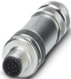
Steckverbinder, Universal, 12-polig, geschirmt, Stecker gerade M12, A-kodiert, Lötanschluss, Rändelmaterial: Zinkdruckguss, vernickelt, Kabelverschraubung Pg9, Kabelaußendurchmesser 6 mm ... 8 mm
