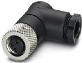
Sensor-/Aktor-Stecker, Buchse, gewinkelt, 3-polig, M8, Lötanschluss, Metallrändel, Kabeldurchmesser max. 5mm
