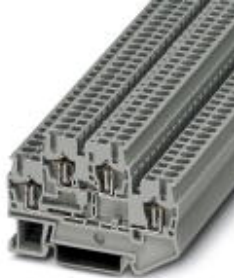
Doppelstock-Zugfederklemme, Querschnitt: 0,08 mm 2 - 4 mm 2 , AWG: 28 - 12, Anschlussart: Zugfederanschluss, Breite: 5,2 mm, Farbe: grau, Montageart: NS 35/7,5, NS 35/15
