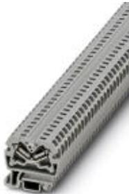
Mini-Durchgangsklemme, Anschlussart: Zugfederanschluss, Querschnitt: 0,08 mm<sup>2</sup> - 4 mm<sup>2</sup>, AWG: 28 - 12, Breite: 5,2 mm, Höhe: 22 mm, Farbe: grau, Montageart: NS 15
