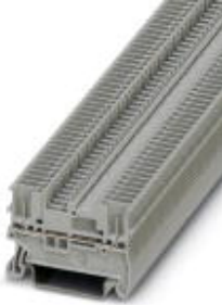
Durchgangsklemme, Anschlussart: Push-in- / Steckanschluss, Querschnitt: 0,14 mm 2 - 1,5 mm 2 , AWG: 26 - 14, Breite: 3,5 mm, Farbe: grau, Montageart: NS 35/7,5, NS 35/15
