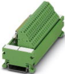
VARIOFACE-Modul, mit Zugfederanschluss und D-Subminiatur-Buchsenleiste, zur Montage auf NS 35/7,5, Polzahl 15
