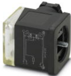
Ventilstecker, 5-polig, Bauform A für Druckschalter, 2 LEDs, ohne Schutzbeschaltung, Schraubanschluss, Kabelverschraubung M16
