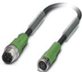
Sensor-/Aktor-Kabel, 4-polig, PUR halogenfrei, schwarzgrau RAL 7021, Stecker gerade M12, A-kodiert, auf Buchse gerade M8, Kabellänge: 0,6 m
