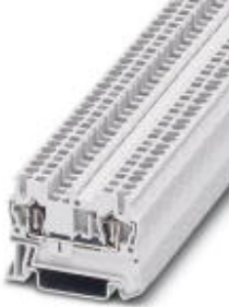
Durchgangsklemme, Anschlussart: Zugfederanschluss, Querschnitt: 0,08 mm 2 - 4 mm 2 , AWG: 28 - 12, Breite: 5,2 mm, Farbe: weiß, Montageart: NS 35/7,5, NS 35/15
