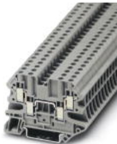
Vierleiter-Universalklemme, Anschlussart: Schraubanschluss, Querschnitt: 0,14 mm 2 - 6 mm 2 , AWG: 26 - 10, Breite: 6,2 mm, Farbe: grau, Montageart: NS 35/7,5, NS 35/15
