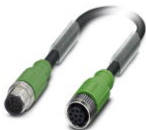
Sensor-/Aktor-Kabel, 8-polig, PUR halogenfrei, schwarzgrau RAL 7021, geschirmt, Stecker gerade M12, A-kodiert, auf Buchse gerade M12, A-kodiert, Kabellänge: 1,5 m
