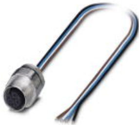
Sensor-/Aktor-Einbaubuchse, 4-polig, M12, A-kodiert, Vorderwand-/Schraubmontage mit Pg9-Gewinde, positionierbar, mit 1,5 m TPE-Litze, 4x 0,34 mm 2
