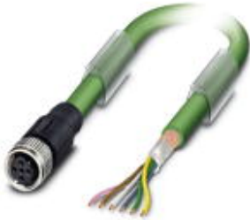
Bussystem-Kabel, INTERBUS, INTERBUS, 5-polig, PUR halogenfrei, grün RAL 6017, geschirmt, freies Leitungsende, auf Buchse gerade M12, B-kodiert, Kabellänge: 10 m
