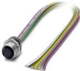
Sensor-/Aktor-Einbaubuchse, 17-polig, M12-SPEEDCON, Vorderwand-/Schraubmontage mit M16 Gewinde, mit 0,5 m PVC-Litze, 17 x 0,14 mm 2
