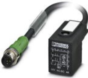
Sensor-/Aktor-Kabel, 3-polig, PUR halogenfrei, schwarzgrau RAL 7021, Stecker gerade M12, A-kodiert, auf Ventilstecker BI (11 mm), mit 1 LED, beschaltet mit Z-Diode, Kabellänge: 0,6 m
