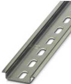
Tragschiene, Material: Stahl verzinkt und dickschichtpassiviert, gelocht, Höhe 7,5 mm, Breite 35 mm, Länge: 755 mm
