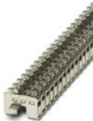
Einspeiseklemme, Anschlussart Schraubanschluss, Belastungsstrom: 125 A, Querschnitt: 0,75 mm 2 - 35 mm 2 , Breite: 12 mm, Farbe: aluminium
