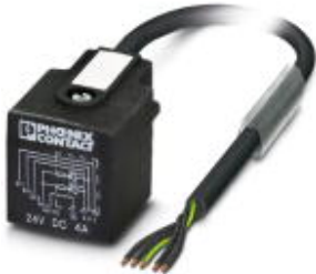
Sensor-/Aktor-Kabel, 5-polig, PUR halogenfrei, schwarz RAL 9005, freies Leitungsende, auf Ventilstecker AD (Druckschalter), mit 2 LEDs, Kabellänge: 3 m
