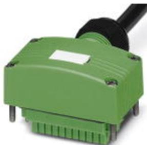
Anschlusshaube, verwendbar für Sensor-/Aktor-Box, Anschlussart: M12-SPEEDCON-Buchse Metall, Anzahl der Steckplätze: 8, Steckplatzbelegung: doppelt, Statusanzeige: Nein; Stammleitungsanschluss: Steckbarer Schraubanschluss 180°, PUR/PVC, Leitungslänge: 10 m, Schirmung: nein
