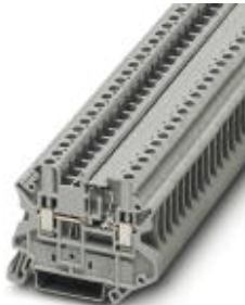
Bauelementreihenklemme, Anschlussart: Schraubanschluss, Querschnitt: 0,14 mm 2 - 6 mm 2 , AWG: 26 - 10, Breite: 6,2 mm, Farbe: grau, Montageart: NS 35/7,5, NS 35/15
