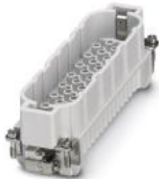
HEAVYCON Stifteinsatz, Serie D64, 64-polig, Crimpanschluss. PE-Anschluss mittels Zughülstechnik.
