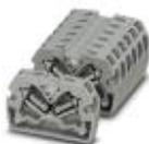
Mini-Durchgangsklemme, Anschlussart: Zugfederanschluss, Querschnitt: 0,08 mm<sup>2</sup> - 4 mm<sup>2</sup>, AWG: 28 - 12, Breite: 5,2 mm, Höhe: 22 mm, Farbe: grau, Montageart: Schraubmontage
