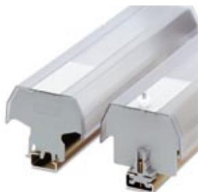
Abdeckprofil, zum Abdecken von Klemmleisten, wird auf Abdeckprofilträger AP 3-TU, AP 3-TNS 35 gerastert, beschriftbar mit Einsteckstreifen AP-ES. An den Enden und in Abständen von ca. 40 cm ist ein Abdeckprofilträger zu setzen. Lieferlänge: 1 m
