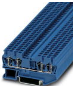
Durchgangsklemme, Anschlussart: Zugfederanschluss, Querschnitt: 0,08 mm 2 - 4 mm 2 , AWG: 28 - 12, Breite: 5,2 mm, Farbe: blau, Montageart: NS 35/7,5, NS 35/15
