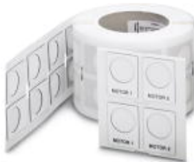
Kunststoffschild mit Bohrung, Rolle, weiß, unbeschriftet, beschriftbar mit: THERMOMARK ROLL, THERMOMARK X, THERMOMARK S1.1, Montageart: Kleben, Schriftfeldgröße: 30 x 12 mm
