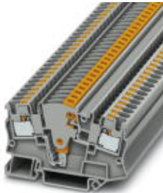
Messwandler-Trennklemme, Anschlussart: Push-in-Anschluss, Querschnitt: 0,2 mm 2 - 6 mm 2 , AWG: 24 - 10, Breite: 6,2 mm, Höhe: 48,8 mm, Farbe: grau, Montageart: NS 35/7,5, NS 35/15
