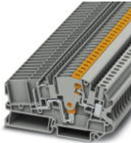
Messwandler-Trennklemme, Anschlussart: Schraub- / Steckanschluss, Querschnitt: 0,14 mm 2 - 6 mm 2 , AWG: 26 - 10, Breite: 6,2 mm, Farbe: grau, Montageart: NS 35/7,5, NS 35/15
