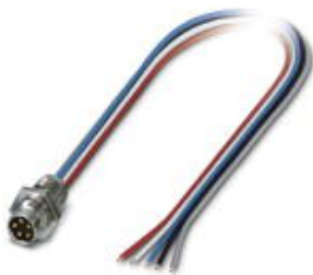
Bussystem-Einbausteckverbinder, Stecker, DeviceNet, 5-polig, M8, Vorderwand-/Schraubmontage mit M8 Befestigungsgewinde, mit 0,5 m PVC-Litze, 5 x 0,25mm 2
