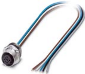
Sensor-/Aktor-Einbaubuchse, 5-polig, M12-SPEEDCON, B-kodiert, Vorderwand-/Schraubmontage mit M16-Gewinde, mit 0,5 m TPE-Litze, 5 x 0,34 mm 2
