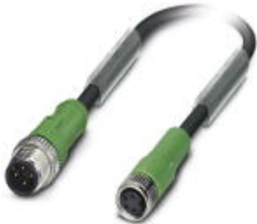
Sensor-/Aktor-Kabel, 4-polig, PUR halogenfrei, schwarzgrau RAL 7021, Stecker gerade M12, A-kodiert, auf Buchse gerade M8, Kabellänge: 0,3 m
