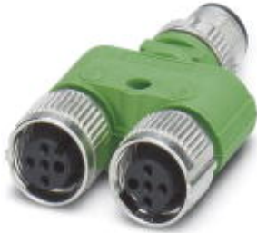
Y-Verteiler, 3-polig + PE, gerader Stecker M12-SPEEDCON auf 2 x gerade Buchse M12-SPEEDCON, PIN 2+4 gebrückt
