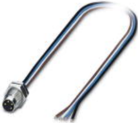
Sensor-/Aktor-Einbaustecker, 4-polig, M8, Hinterwand-/Schraubmontage mit M8-Gewinde, mit 0,5 m TPE-Litze, 4 x 0,25 mm 2
