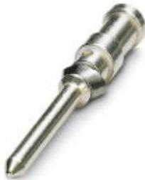
Gedrehter 1,6er Crimpkontakt, Stift-Einzelkontakt, Aderquerschnitt 0,14 bis 0,37 mm<sup>2</sup>, versilbert
