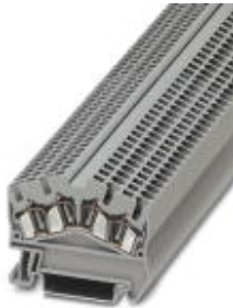
Durchgangsklemme, Anschlussart: Zugfederanschluss, Querschnitt: 0,08 mm 2 - 4 mm 2 , AWG: 28 - 12, Breite: 5,2 mm, Farbe: grau, Montageart: NS 35/7,5, NS 35/15
